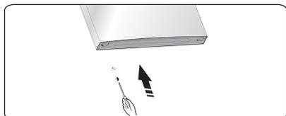
7. Desatornille los dos tornillos autorroscantes de la brida especial que se usan para fijar la pieza de la bisagra central y, a continuación, retire la pieza de la bisagra central que sujeta la puerta inferior.
