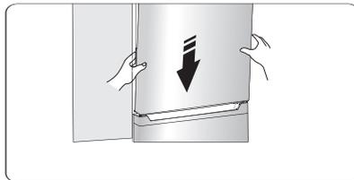
15. Cambie la pieza de la bisagra superior y coloque el eje de la bisagra superior en el orificio superior de la puerta superior y ajústela en la posición de la puerta superior (sujete la puerta superior con la mano mientras lo haga), fijando la pieza de la bisagra superior con los tornillos autorroscantes de la brida especial.
