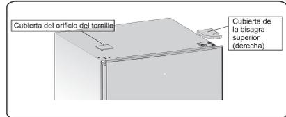
3. Desatornille los tornillos autoroscantes de la brida especial que se usan para fijar la pieza de bisagra superior derecha con un destornillador o una llave de 8 mm (sujete la puerta superior con la mano mientras lo haga).
