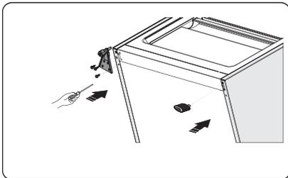
12. Cambie la puerta inferior a la posición de propiedad, ajuste la pieza de bisagra inferior colocando el eje de bisagra en el orificio inferior de la puerta inferior y, a continuación, apriete los tornillos.
