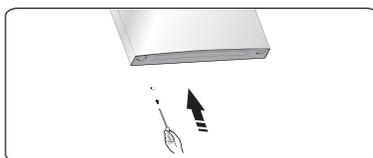
9. Cambie las cubiertas de los orificios de los tornillos de la parte central de la placa de cubierta de izquierda a derecha (como se muestra en la figura siguiente).
